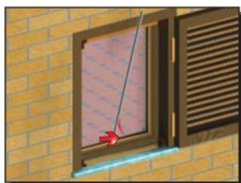
06 Usuń zabezpieczenie taśmy samoprzylepnej z listwy montażowej (prawa strona)
