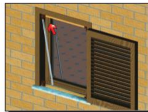
12 Wsuń listwę montażową pomiędzy narożniki profilu górnego i dolnego (lewa strona)
