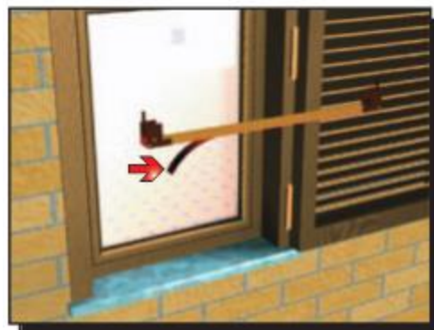
02 Usuń zabezpieczenie taśmy samoprzylepnej z profilu dolnego
