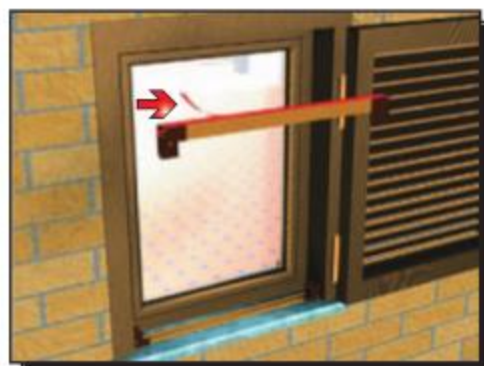
04 Usuń zabezpieczenie taśmy samoprzylepnej z profilu górnego
