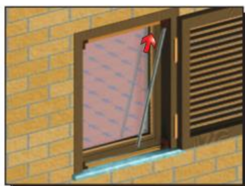
07 Wsuń listwę montażową pomiędzy narożniki profilu górnego i dolnego (prawa strona)
