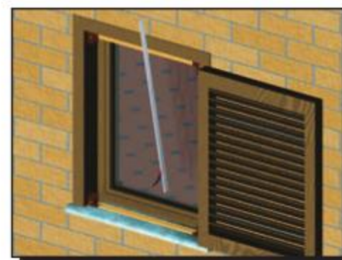
11 Usuń zabezpieczenie taśmy samoprzylepnej z listwy montażowej (lewa strona)
